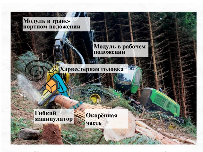
Харвестер с модулем окорки в процессе работы
